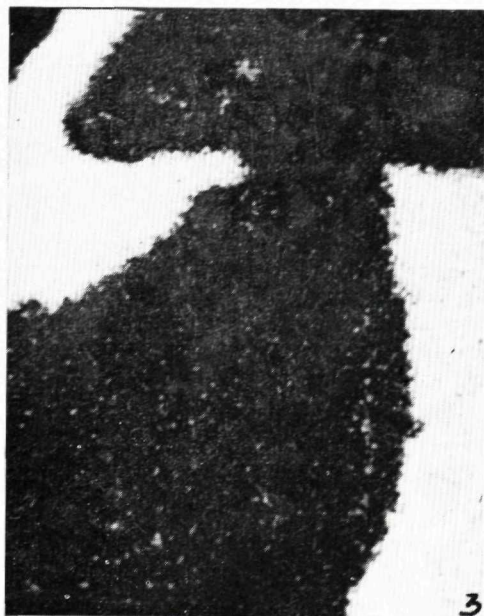
Obr. 1 RTG obraz Ca - K 2 anhydritu v dolomite, zväčš. 200 ×, GK-IV, 1024,0 m. — Obr. 2 RTG obraz S - K anhydritu v dolomite, zväčš. 200 ×, GK-IV, 1024,0 m. — Obr. 3 RTG obraz Mg - K 2 dolomit obklopujúci anhydrit, zväčš. 200 ×, GK-IV, 1024,0 m. — Obr. 4 RTG obraz Si - K 2 , kremňa a fľová zložka v dolomite, zväčš. 200 ×, GK-IV, 1024,0 m. — Foto: J. Kolman
