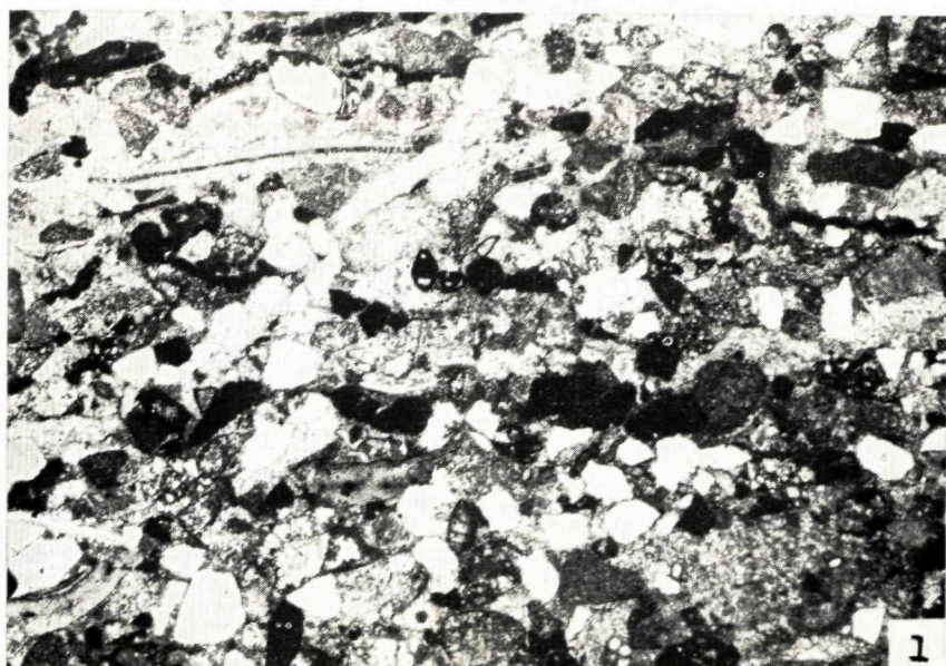
Obr. 1 Detritický vápeneč s úlomkami karbonátov, kremeňa a prierezom diskocyklíny. Zv. 25 ×
