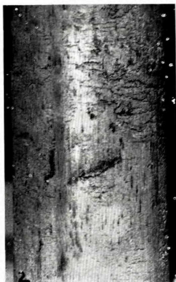
Obr. 1 Vzorka spraší W 3 — na reze vidno makropórovitú štruktúru (pórovitosť 44 — 46 %), obsah konkrécií Mn a \text{CaCO}_3
